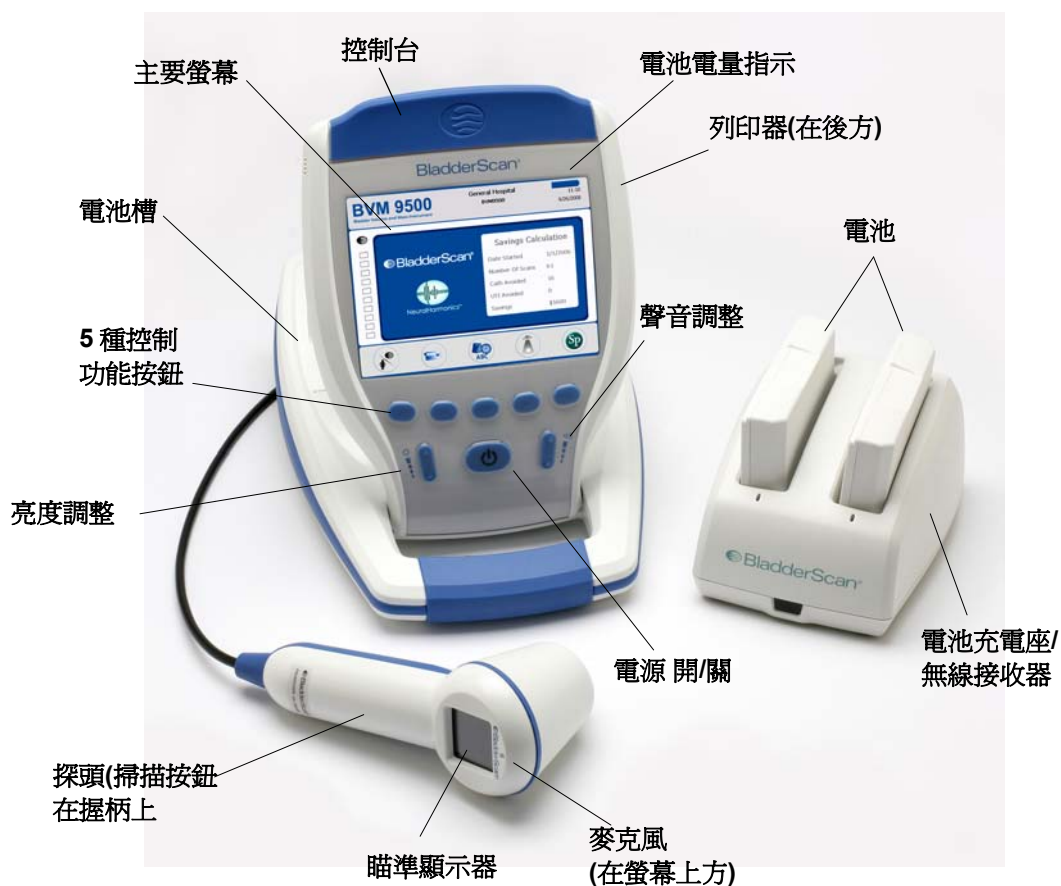
圖 1. BladderScan® BVM 9500 控制按鈕與指示器
